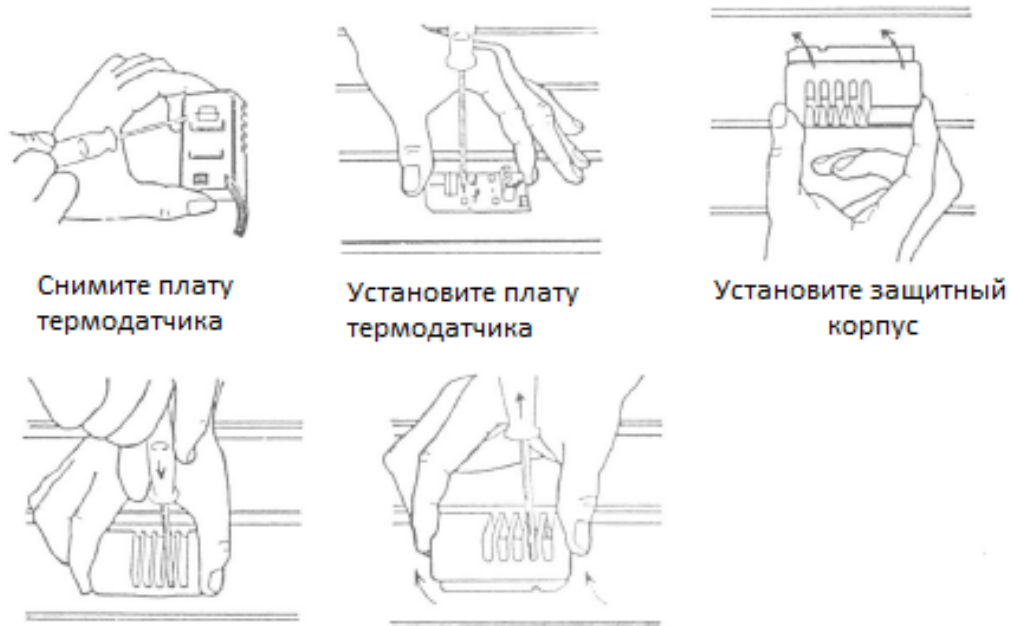
Схема 3-3 Установка термодатчика
